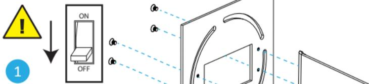
**1** Un choc électrique peut entraîner des blessures graves ou la mort. Assurez-vous que le disjoncteur est réglé sur OFF avant l'installation. Doit être installé par un électricien qualifié.
