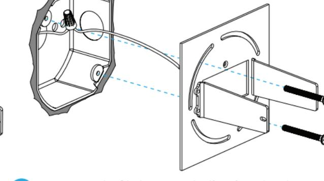
**3** Connectez le fil de terre de l'arrière du plaque de montage à la boîte de jonction. Installez la plaque de montage carrée sur le boîte de jonction à l'aide des deux vis fournies. Utilisez la plaque rectangulaire si vous avez une boîte pratique.
