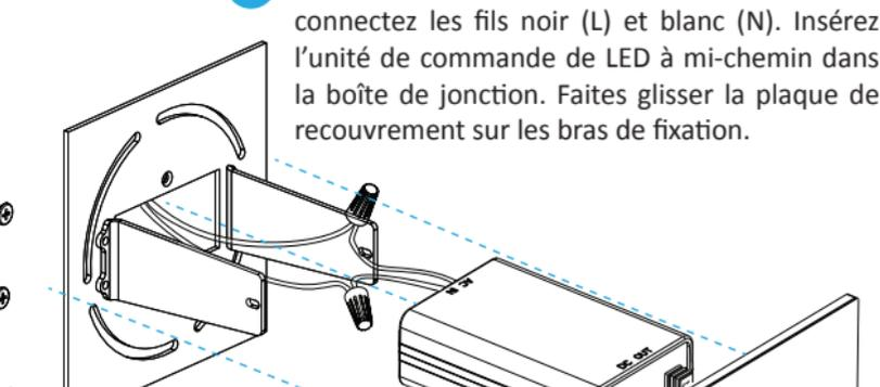
**4** En utilisant les connecteurs à visser fournis, connectez les fils noir (L) et blanc (N). Insérez l'unité de commande de LED à mi-chemin dans la boîte de jonction. Faites glisser la plaque de recouvrement sur les bras de fixation.
