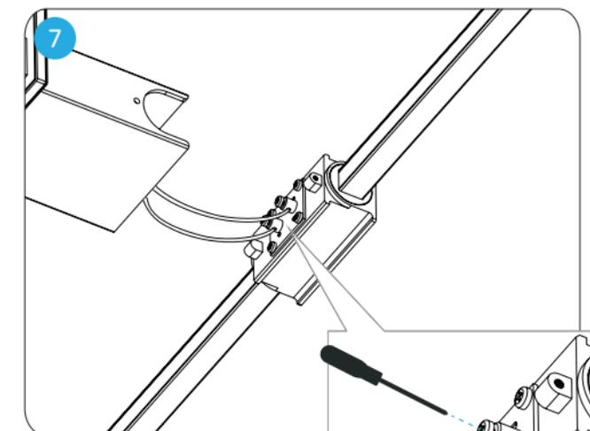
**7** Branchez les fils +positif (ROUGE) et -négatif (NOIR) du pilote de DEL aux bornes de câblage + positives et -négatives de la lampe.
