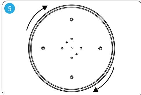
Une fois que l'applique murale Ramen est insérée sur la plaque arrière sur le mur, tournez-le dans le sens des aiguilles d'une montre jusqu'à ce qu'il s'enclenche.
