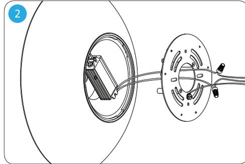
À l'aide des connecteurs de câble fournis, connectez les fils. Fixez le fil de terre à la vis verte de l'unité.
