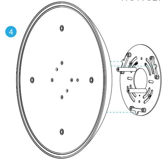
Insérez l'applique murale Ramen sur la plaque arrière du mur en alignant les fentes. Alignez les emplacements où se trouvent les points rouges.
