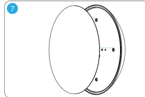
Enfin, placez magnétiquement sur la plaque de couverture. (note: vous pouvez retirer la plaque de recouvrement à l'aide de l'aimant fourni.)
