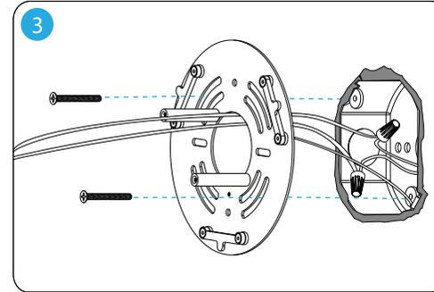
Fixez la plaque arrière de l'applique murale Ramen au boîte de jonction avec les vis fournies. ⚠ Pour une installation en milieu humide: une fois la plaque arrière fixé à la boîte de jonction, utilisez un calfeutrage transparent (c.-à-d. mastic silicone intérieur / extérieur) pour décrire à l'extérieur de la plaque arrière où elle rencontre le mur.
