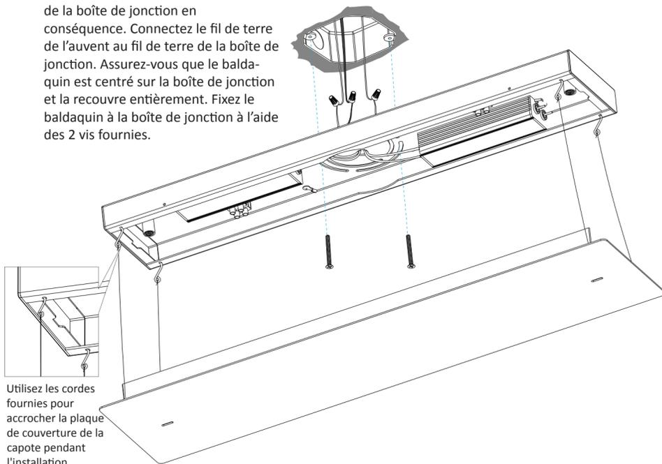
Utilisez les cordes fournies pour accrocher la plaque de couverture de la capote pendant l'installation
